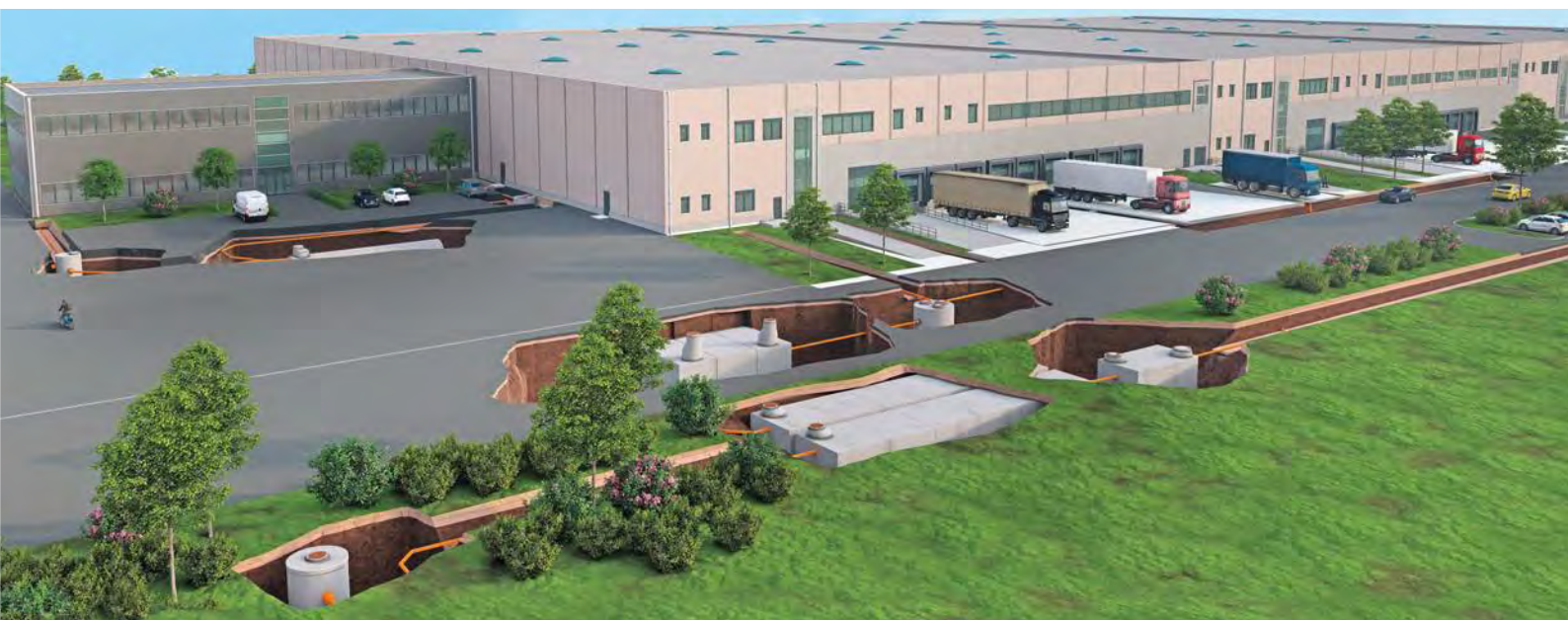
FUCHS Anlagen speichern, behandeln, drosseln oder lassen Regenwasser oberflächennah versickern
