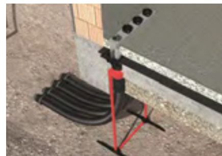
Dampfsperrfolien lassen sich an den aufgerauten Spachtelflansch anbinden. Die Höhe des Estrichaufsatzes lässt sich mithilfe der Höhenfixierung an den Fußbodenaufbau anpassen.
