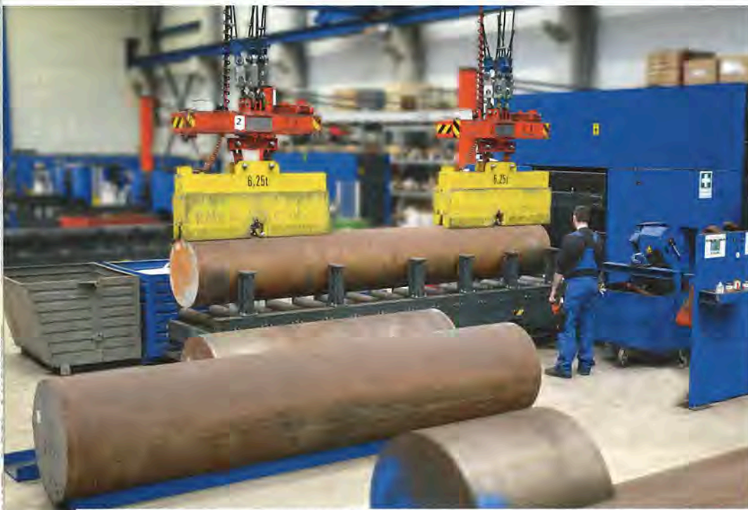
Auf fünf Sägeautomaten werden Vollmaterialien bis 800 mm Durchmesser rund um die Uhr zugeschnitten.
