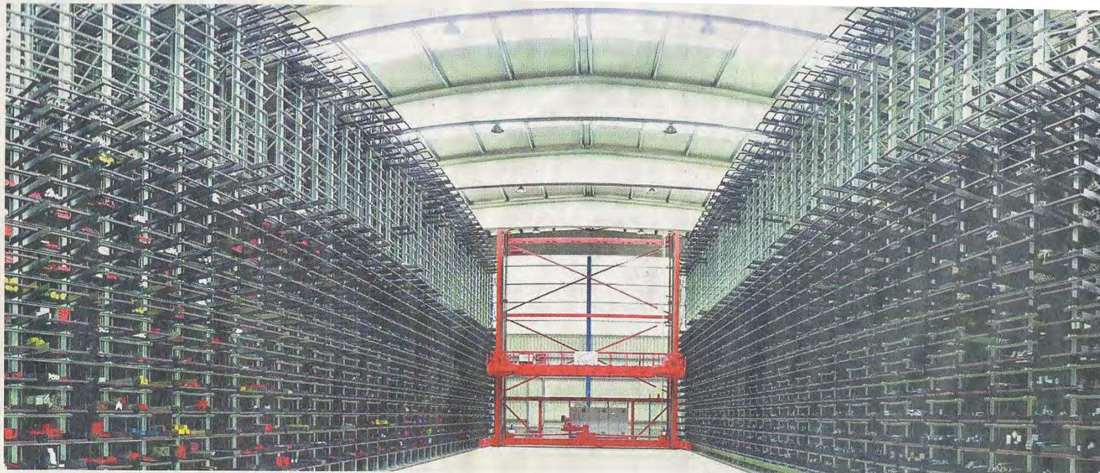
Das neue Hochregallager der Firma Bieber+Marburg umfasst 2200 Fächer. Das Ein- und Auslagern funktioniert vollautomatisch.
