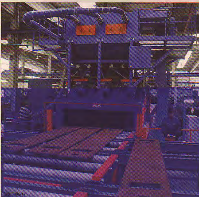
Aufbau einer Strahlanlage (Bild: Agtos)
