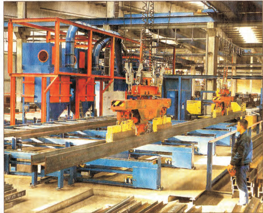
Lange und schwere Stahlträger werden von der neuen Anlage automatisch entrostet. Statt nach acht Tagen kann „Bieber+Marburg“ jetzt nach zwei Tagen die Produkte ausliefern. (Foto: privat)
